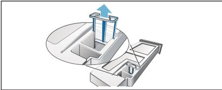
4. Reinigen Sie das Sieb unter fließendem warmen Wasser oder in der Geschirrspülmaschine.
