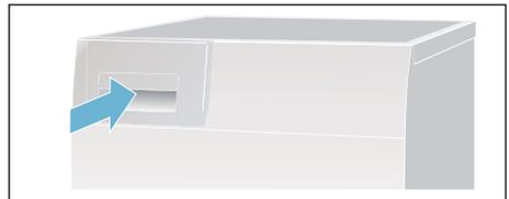
**Hinweis:** Das Sieb im Kondenswasser-Behälter filtert das Kondenswasser, das zur automatischen Reinigung Ihres Trockners verwendet wird. Das Sieb wird durch Entleeren des Kondenswassers gereinigt. Prüfen Sie das Sieb trotzdem regelmäßig auf verbliebene Ablagerungen und entfernen diese. Siehe → Seite 31.
