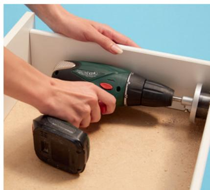
**Bohre** mit dem Akkuschauber und dem Lochbohraufsatz das vorgezeichnete Loch in die Schublade.
