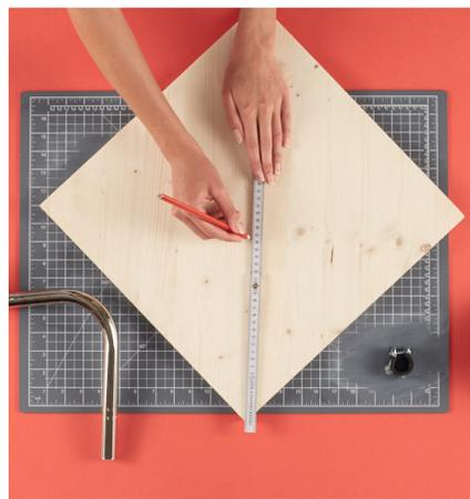
Nun legst du die Positionen für Sattel und Lenkstange fest und **zeichnest** die **Bohrlöcher** mittig für Rohrschellen und die Wandmontage an.
