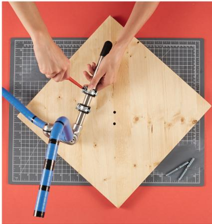
Lege die **Rohrschellen** um den Lenker, hinten fest anziehen. Drehe die Stockschrauben in die Rohrschellen und ziehe sie durch die vorgebohrten Löcher durch das Brett.
