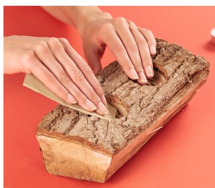
Damit die Löcher glatt und splitterfrei werden, bearbeitest du sie mit dem **Schleifpapier**.
