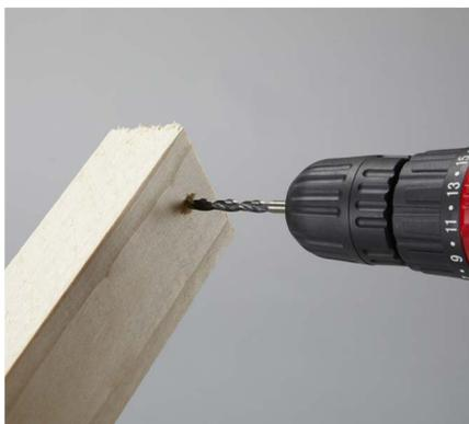
Bohre nun mit dem **Holzbohrer** die Löcher für die Schrauben vor.
