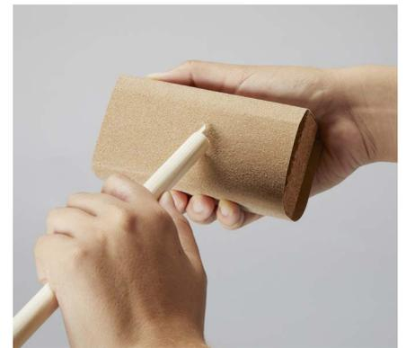
**Schmirgele** anschließend die abgesägten Enden ab.
