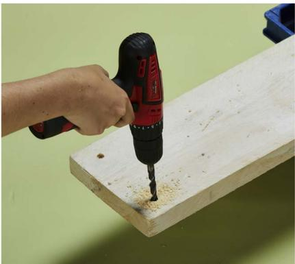
Bohre zunächst mit dem **Holzbohrer** vier Löcher in das Brett. Der Durchmesser der Löcher richtet sich nach der Dicke des Seils.
