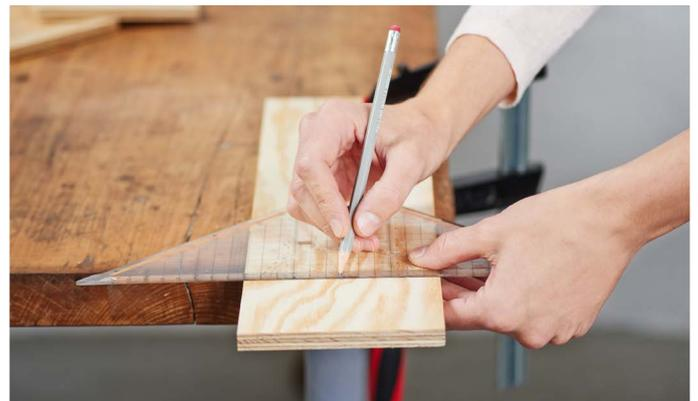
Nimm dir nun eines der langen Bretter und zeichne ein, wo die Flaschen später stehen sollen. Ermittle dafür mit dem Geodreieck die Mitte des Brettes und markiere die Stellen, wo du später mit der **Lochsäge** ansetzen wirst. Du kannst auch den Umriss des zu sägenden Loches mit dem Zirkel anzeichnen. Achte darauf, dass die Durchmesser mit dem Lochaufsatz und den Flaschenhälsen übereinstimmen.
