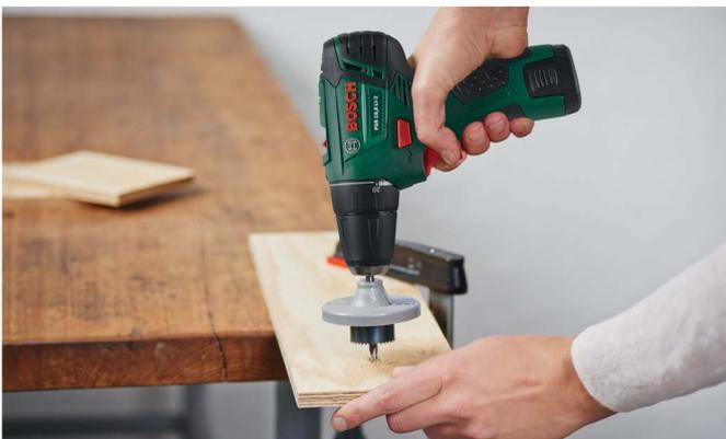
Wähle einen zum Durchmesser deiner Flaschenköpfe passenden **Lochsägeaufsatz** und setze den Akkuboehrschrauber in der Mitte der eingezeichneten Flaschenposition an. Bohre nun mit leichtem Druck die 5 benötigten Löcher in das Brett.
