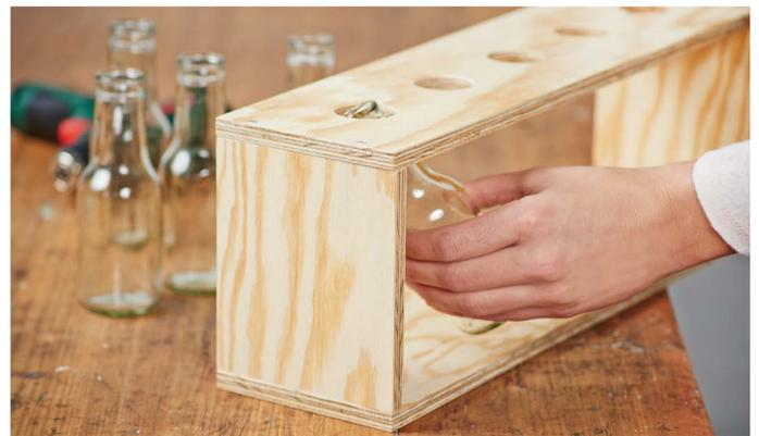
Nun werden die 4 Bretter zusammengeschaubt. Dafür brauchst du helfende Hände, die Brett und Seitenteil aneinanderdrücken, während du schraubst. Platziere die Schrauben etwa 2 cm von den Ecken entfernt und bohre sie in beide Bretter hinein. Das Gleiche mit dem anderen Seitenteil. Dann verschraubst du die Oberseite mit den beiden Seitenteilen. Wenn die Holzkonstruktion steht, werden die **Flaschen** in die Löcher eingesetzt. Jetzt Wasser und Blumen rein – fertig!
