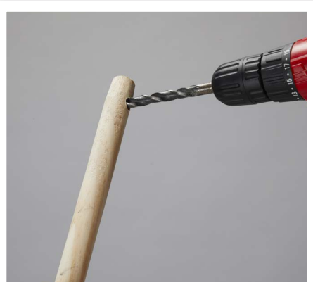
Bohre am Ende eines jeden Teils mit dem Bohrer ein Loch für die spätere (optionale) Befestigung mit den Heringen im Boden.
