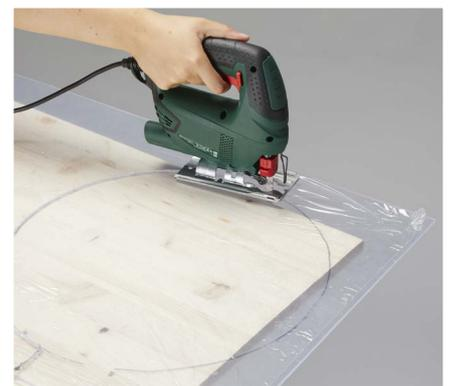
Säge mit der **Stichsäge** (Metallsägeblatt) den Kreis aus dem Plexiglas aus ...
