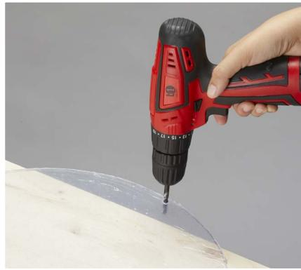
... Bohre mit dem **Metallbohrer** in gleichen Abständen mehrere Löcher in die Plexiglasscheibe ...
