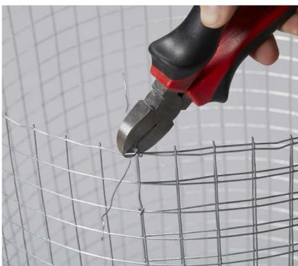
... und kneife den überstehenden **Draht** mit dem Seitenschneider ab.
