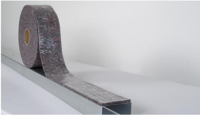
Beklebe zunächst das UW-Profil auf ganzer Länge mit **einseitig klebendem Anschlussdichtband**. Nach der Montage wird die Anschlussdichtung nicht nur alle Zwischenräume verschließen, sondern gleichzeitig die Schallübertragung reduzieren. Ist das UW-Profil zu lang, kannst du es **mit einer Blechschere** kürzen und anschließend an der Decke verschrauben.
