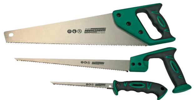
**Fuchsschwanz:** wiegt wenig und ist ideal zum Schneiden von kleinen Werkstücken. Seinen Namen hat er von dem ungespannten, konisch zulaufenden Sägeblatt. Dieses ist recht dick und steif und kommt ohne verstärkenden Rücken aus – und ist deswegen in der Schnitttiefe nicht eingeschränkt. Wegen seiner groben Zähne eignet sich diese Säge besonders für das Zersägen von Kunststoff und Holz, hinterlässt aber auch eine entsprechend grobe Schnittkante.
