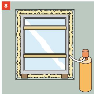
Zwischenräume zwischen Mauerwerk & Blendrahmen mit 2-Komponenten Montageschaum füllen. Reste vom Schaum abschneiden. Nach Aushärten des Schaumes können die Keile entfernt werden. Die unteren Trageklötze verbleiben in der Anschlussfuge und verhindern das „Setzen“ des Fensters.
