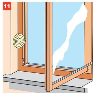
Selbstklebende Schaumstoffdichtung in unterschiedlichen Stärken können im Fensterfalz angeklebt werden.
