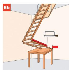
Der untere Treppenteil liegt auf einem Hocker/Tisch auf, da er ggf. zu lang ist. Man legt ein Richtscheit (Holzplatte) an und misst bis zum Boden. Dann hält man das Richtscheit an den abgewinkelten unteren Teil und kann die Treppe an der richtigen Stelle kürzen, damit sie sicher auf dem Boden steht.
