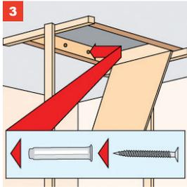
Verdübeln und verschrauben Sie den Kasten durch dessen Laibung hindurch. Rechnen Sie mit mind. vier langen (100mm) Schrauben je Längsseite und je zwei pro Kopfseite.
