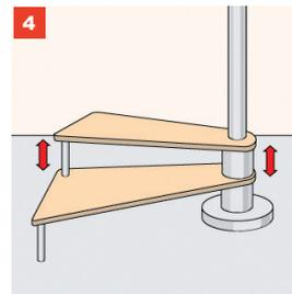
Mit kurzen Gewindestangen wird die Verbindung der Stufen untereinander gesichert. Darüber werden passende Distanzstücke geschoben, die in ihrer Länge genau der der Zwischenringe entsprechen.
