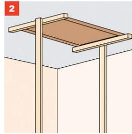
Mit einem Latten-T stellen Sie sicher, dass der Leiterkasten geschlossen während der Montage genau mit der Unterkante der Decke abschließt.
