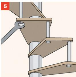
Die Gewindestangen ziehen Sie von der Stufenunterseite aus fest. Die Distanzstücke sollten Sie dabei so ausrichten, dass sie mittig stehen und beim Festschrauben nicht verkanten.
