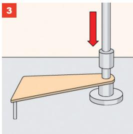
Die Grundplatte der Spindel verschwindet unter der mitgelieferten Abdeckung. Nun werden abwechselnd die Zwischenringe und die einzelnen Stufen über die Spindel geschoben. Richten Sie die oberste Stufe (das Podest) auf dem Boden exakt aus.
