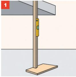
Die Kante des Obergeschosses wird mit einem Richtscheit und der Wasserwaage auf den Boden herunter geleitet. Markieren Sie sich diesen als Mittelpunkt.
