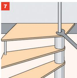
Als oberen Anschluss aller Stufen drehen Sie eine Spannmutter auf die Gewindestange der Spindel. Sie hält alle Stufen zusammen. Darüber wird die Spindelverlängerung geschoben.
