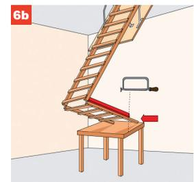
Der untere Treppenteil liegt auf einem Hocker/Tisch auf, da er ggf. zu lang ist. Man legt ein Richtscheit (Holzlatte) an und misst bis zum Boden. Dann hält man das Richtscheit an den abgewinkelten unteren Teil und kann die Treppe an der richtigen Stelle kürzen, damit sie sicher auf dem Boden steht.
