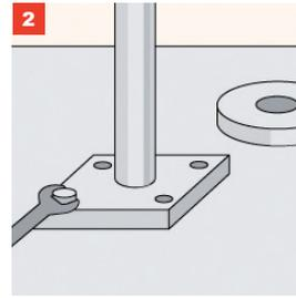
Auf dem markierten Mittelpunkt verschrauben Sie die Grundplatte der Treppenspindel im Boden. Bohren Sie bis in den Beton des Bodens und setzen Sie mindestens vier Dübel ein.
