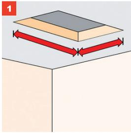
Der Deckenausschnitt muss genau den Maßen des Leiterkastens angepasst werden. Hierbei ist die Beratung/Hilfe eines Fachmanns ratsam.
