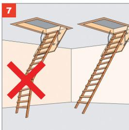
Nun die an beiden Seiten gekürzte Leiter ausklappen. Sie muss insgesamt eine gerade Linie ergeben und fest auf dem Fußboden aufsitzen. Erst wenn sie stabil steht, erfolgt die Generalprobe.
