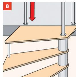
Die Geländerstützen für das Obergeschoss verdübeln Sie im Boden. Das Geländer ist später sowohl mit dem Geländer des Obergeschosses als auch mit der Spindelverlängerung verbunden.
