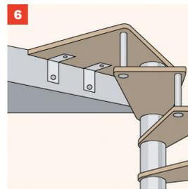
Die letzte Stufe, das Podest, fixieren Sie sowohl an der Spindel als auch an der oberen Geschossdecke. Verdübeln Sie zwei Stahlwinkel so, dass die Oberkanten von Stufe und Geschossdecke flächenbündig sind.
