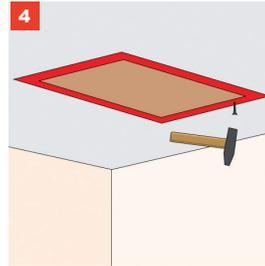
Die Randabdeckleisten werden auf 45°-Gehung geschnitten (d.h. die Hölzer werden abgeschragt um eine 90°-Eckverbindung zu erhalten), bevor sie von unten mit dem Kasten vernagelt werden.
