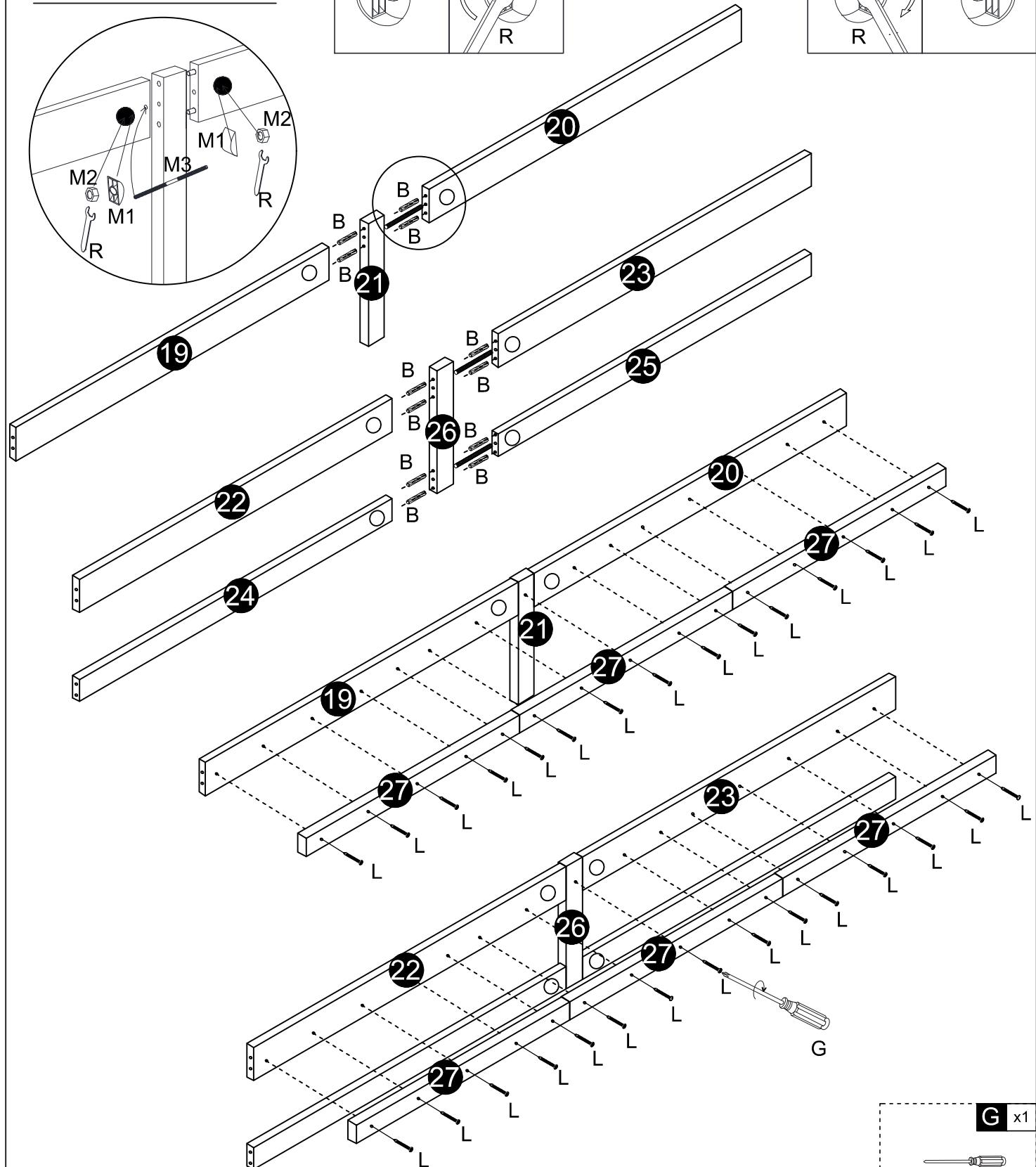
Man beachte die unterschiede zwischen den zahnen der nr. 21 und der nr. 26 innen und außen. Als die montage fertig war, wurden die teller 21 mit den platten 19 und 20 ebenerdig und die teller 26 mit den platten 22 und 23 24 und 25.
