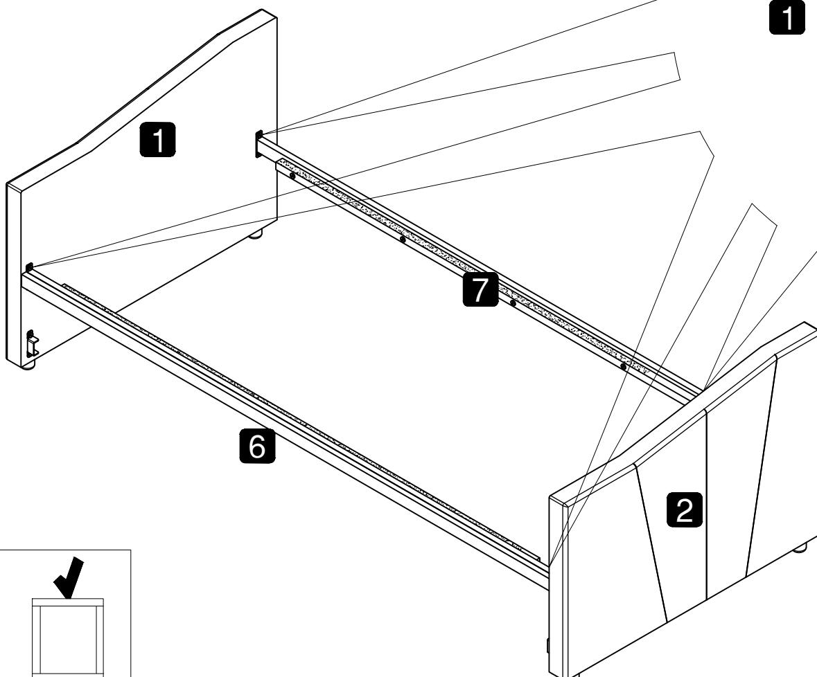
(Verwenden Sie den Sechskantschlüssel (K) und die Schraube (A), um den Bettbalken (6&7) mit dem Handlauf (1&2) zu verbinden. Achten Sie auf die Richtung, wie in der Abbildung gezeigt. Die konvexen flachen Nudeln zeigen nach innen und der Klettverschluss nach oben.)
