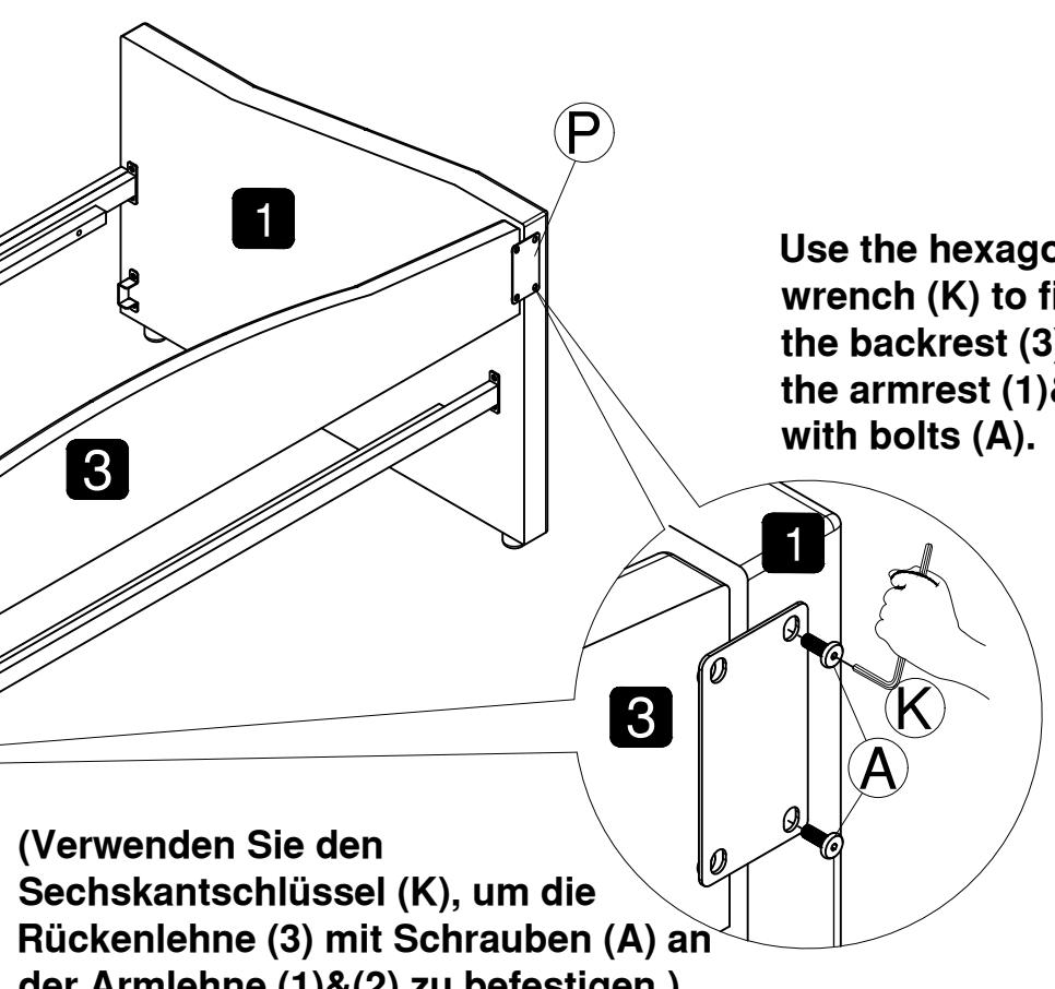
(Verwenden Sie den Sechskantschlüssel (K), um die Rückenlehne (3) mit Schrauben (A) an der Armlehne (1)&(2) zu befestigen.)
