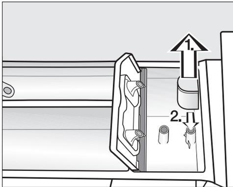
1. Saugheber aus der Kammer ☼ herausziehen und unter fließendem warmem Wasser reinigen. Das Rohr, über das der Saugheber gesteckt wird, ebenfalls reinigen.
