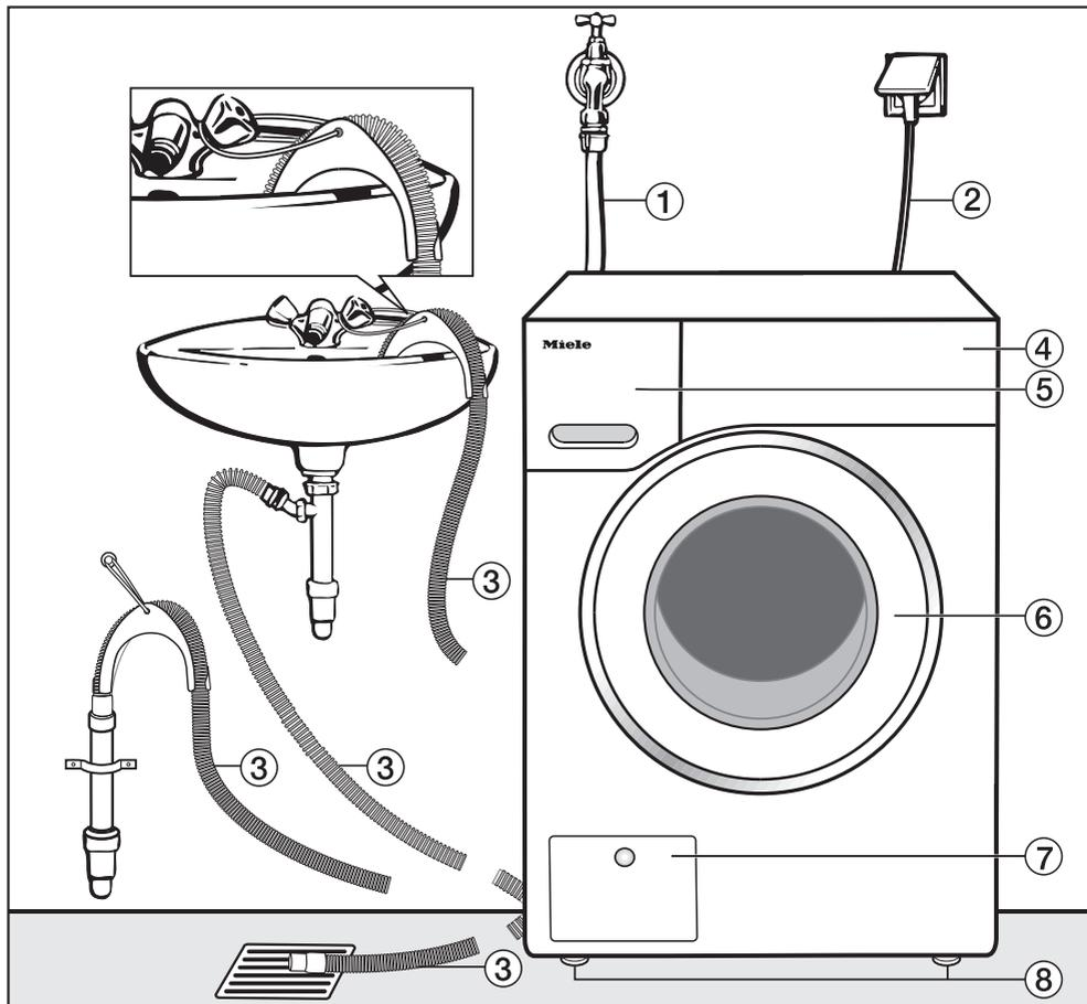
① Wasserzulaufschlauch (druckfest bis 7.000 kPa)
