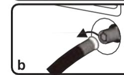
1. Localisez l'orifice de vidange à l'arrière de l'appareil. Tourner le capuchon du bouchon d'eau.
