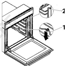
Um die Einschubschienen-Gitter, ggf. zusammen mit den seitlichen katalytischen Platten, wieder einzusetzen, gehen Sie in umgekehrter Reihenfolge vor wie zuvor beschrieben.
