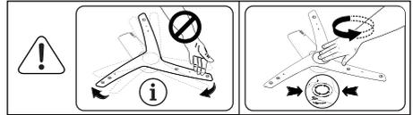
**i** Versuchen Sie nicht, den Sprüharm durch Druck auf seine Enden zu drehen. Durch den Versuch, die Endabschnitte zu drehen, könnte das Getriebesystem im Sprüharm brechen.
