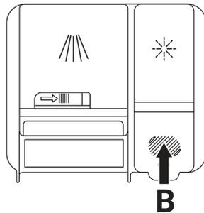
4. Falls nach dem Spülen Flecken am Geschirr verbleiben, stellen Sie eine höhere Stufe ein. Sollte eine bläuliche Färbung nach dem Abwischen des Geschirrs von Hand zurückbleiben, wählen Sie eine niedrigere Stufe. Ihr Gerät ist ab Werk auf Position 3 voreingestellt.
