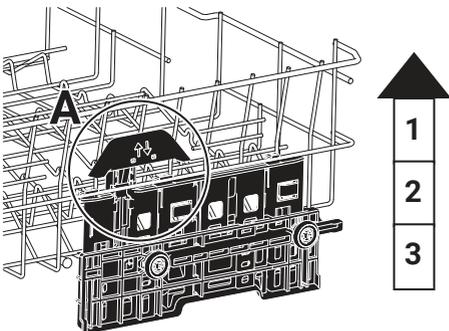
1. Um den Korb anzuheben, halten Sie die Drähte des Korbs und ziehen Sie den Korb mit beiden Händen nach oben, während sich der Korb in der untersten Position befindet (B).
