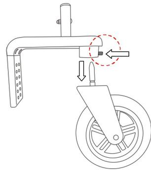
2) Montieren Sie die Fußablage an der Sitzstütze:
