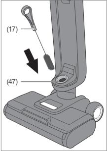
3. Benutzen Sie die Reinigungsbürste (17), um Verschmutzungen und Fremdkörper aus dem Ellenbogen (47) zu entfernen.
