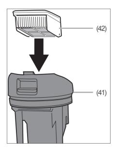
2. Setzen Sie die Filtereinheit (42) in die Schmutzwassertankabdeckung (41) ein.
