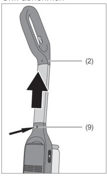
Drücken Sie mit einem spitzen Gegenstand, z. B. mit einem Schraubenzieher, auf den Entriegelungsknopf (9) und ziehen Sie den Griff (2) ab.
