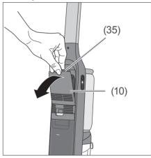
Akkufachabdeckung (10) abnehmen: Drücken Sie die Entriegelungstaste (35) und entnehmen Sie die Akkufachabdeckung.
