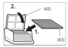
Legen Sie den HEPA-Filter (43) in die Filtereinheit (42) ein und schließen Sie die Filtereinheit.
