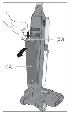
Halten Sie das Gerät mit einer Hand fest. Halten Sie den Frischwassertank (12) mit der anderen Hand und drücken
