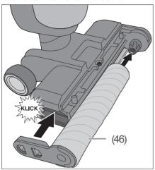
Schieben Sie die Bürstenrolle (46) seitwärts auf die Halterung. Orientieren Sie die Bürstenrolle dabei so, dass die Bürstenverriegelung (13) in die Halterung einrastet.
