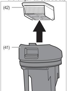
3. Ziehen Sie die Filtereinheit (42) aus der Schmutzwassertankabdeckung (41).
