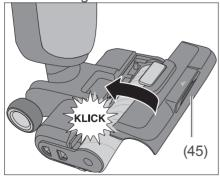
Platzieren Sie Bürstenabdeckung (45) über der Bürstenrolle (46) und drücken Sie sie nach unten, bis sie hörbar einrastet.
