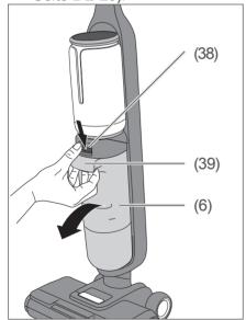
2. Halten Sie das Gerät mit einer Hand fest. Halten Sie den Schmutzwassertank-Griff (39) mit der anderen Hand und drücken Sie mit dem Daumen die Entriegelungstaste (38) nach unten.
