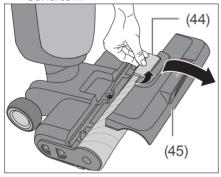
Ziehen Sie den Entriegelungsgriff (44) der Bürstenabdeckung (45) nach oben, um die Bürstenabdeckung abzunehmen.
