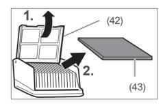
4. Klappen Sie die Filtereinheit auf und nehmen Sie den HEPA-Filter (43) aus der Filtereinheit
