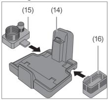
Stecken Sie die Verbindungsstücke am Bürstenhalter (15) und am Zusatzhalter (16) so in die Öffnungen an den Seiten der Ladestation (14), dass Bürstenhalter und Zusatzhalter hörbar einrasten.
