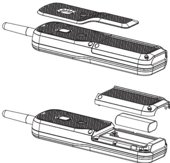
2. Setzen Sie den Deckel wieder auf und schrauben Sie diesen wieder fest. Zuletzt den Gürtelclip anschrauben.
