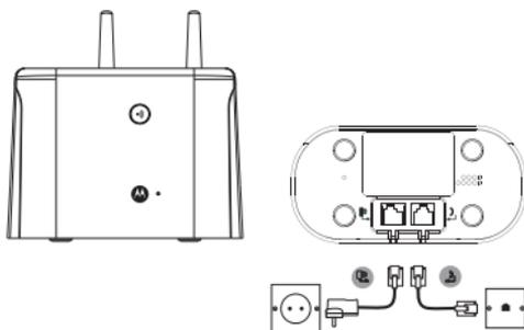
1. Das Telefonkabel an der entsprechend gekennzeichneten Buchse
