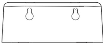
2. Stecken Sie, falls nötig, Dübel hinein und schrauben Sie dann die Schrauben so weit hinein, dass sie 5 mm von der Wand hervorstehen. Hängen Sie daran das Telefon auf.
