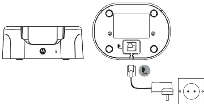
1. Netzkabel mit dem roten Stecker an der entsprechend gekennzeichneten Buchse an der Unterseite des Ladegeräts anschließen und das andere Ende des Kabels an einer Steckdose einstecken.
