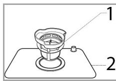
Das Filtersystem verhindert, dass größere Mengen an Speiseresten oder Fremdkörpern in das Spülsystem gelangen.
