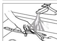
Vápník a nečistoty z vody na oplachování mohou ucpat trysky a ložiska v rozprašovacím rameni. Výstupy trysek rozprašovacího ramena kontrolujte pravidelně kvůli ucpání.
