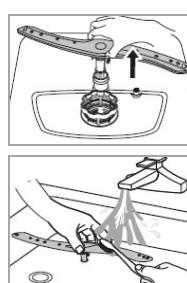
Dýzy a ložiská striekacieho ramena môžu blokovať kotolný kameň a nečistoty z oplachovacej vody. Výstupné dýzy striekacieho ramena pravidelne kontrolujte, či nie sú upchané.
