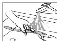
Kalk und Verunreinigungen aus dem Spülwasser können Düsen und Lagerungen des Sprüharms blockieren. Kontrollieren Sie die Austrittsdüsen des Sprüharms regelmäßig auf Verstopfungen.
