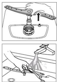
La cal y las impurezas del agua de lavado pueden obstruir boquillas y rodamientos del brazo de rociado. Compruebe con regularidad si existen obstrucciones en las boquillas de salida del brazo de rociado.
