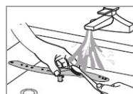
Le calcaire et des impuretés peuvent obstruer les jets et s'infiltrer dans les roulements du bras de cyclage. Contrôlez les jets du bras régulièrement et retirez toute obstruction.
