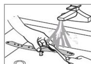
Kamień i zanieczyszczenia z wody zmywającej mogą blokować dysze i łożyska ramienia spryskiwacza. Regularnie sprawdzaj dysze wylotowe ramienia spryskiwacza pod względem zatorów.
