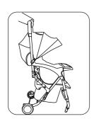
1.Doos openen en onderdelen eruit halen, stuur vasthouden en omhoog trekken, vouwgewricht opklappen, hoor "klik" betekent dat het klapscharnier vergrendeld is. tijd druk op het stuur, vouwgewricht mag er niet uit vallen. de kinderwagens kunnen niet vallen of
