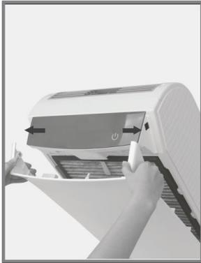
1. Öffnen Sie die vordere Filterklappen-Abdeckung
