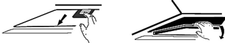
Entfernen Sie den/die Fettfilter. Die Kohlefilter werden auf den beiden Seiten des Motorgehäuses befestigt.
