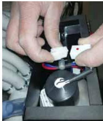
3. Schritt: Weiße Verbindungsstücke entkuppeln
