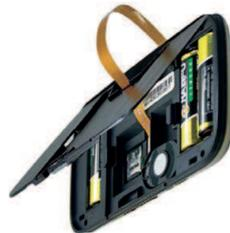
Setzen Sie den Batteriefachdeckel wieder auf. Das Flachbandkabel passt durch eine kleine Öffnung, die sich am Deckel befindet.
