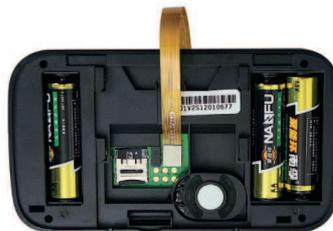
Schließen Sie das Flachbandkabel an, indem Sie es auf den Anschluss schieben. Sie hören ein "Klicken" beim Verriegeln auf der Leiterplatte. Stellen Sie sicher, dass das Kabel richtig herum angebracht wird, wie in der Abbildung dargestellt.
