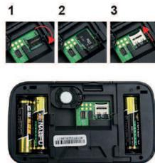
Öffnen Sie den Batteriedeckel des Innenmonitors (A) und legen Sie die Micro-SD-Karte ein. Legen Sie dann 3 x AA-Batterien gemäß angezeigter Polarität ein.
