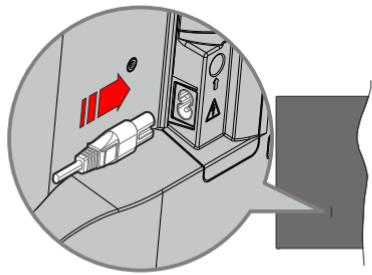
Inserire un'estremità (la spina a due fori) del cavo di alimentazione staccabile in dotazione nell'ingresso del cavo di alimentazione sul lato posteriore del televisore, come mostrato sopra. Quindi inserire l'altra estremità del cavo di alimentazione nella presa di corrente.
