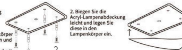
2. Biegen Sie die Acryl-Lampenabdeckung leicht und legen Sie diese in den Lampenkörper ein.
