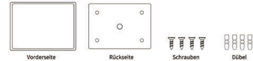
1. Öffnen Sie die Verpackung und nehmen Sie die Deckenleuchte und die Zubehör vorsichtig raus. Befestigen Sie den Lampenkörper mit den beiliegenden Dübeln und Schrauben an der Decke. Verbinden Sie die Stromkabel mit der Lampe mit Hilfe der Kabelklemme.
