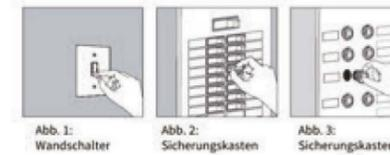
Abb. 2: Schalten Sie die Sicherung für den Raum in dem die Lampe angebracht werden soll im Sicherungskasten auf "AUS". Wenn Sie sich unsicher sind, welche Sicherung für den Raum gilt, schalten Sie bitte die Hauptsicherung auf "AUS" bevor Sie mit der Installation beginnen.
