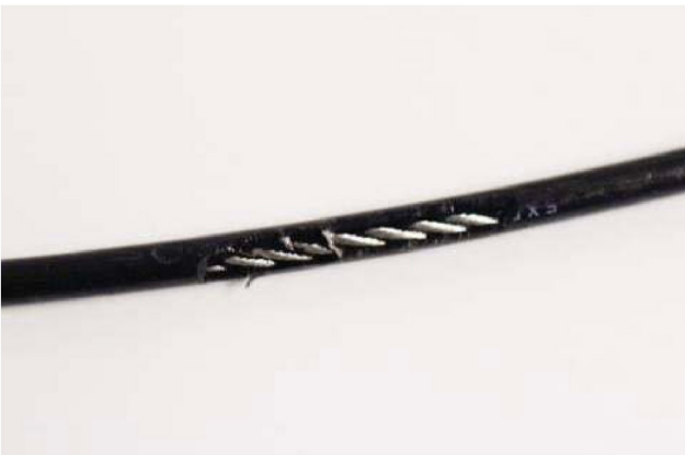
Riss im Kabelmantel
