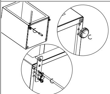
Montieren Sie die Aufhängung auf der gegenüberliegenden Seite. Setzen Sie die beiden verstellbaren Füße wieder ein.
