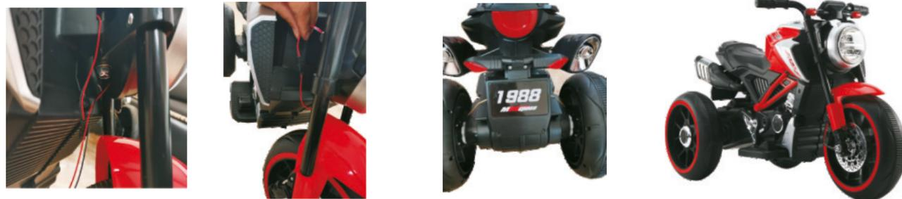
Verbinden Sie die Stecker vom Lenker zur Karosserie und das rote Pluskabel mit der Batterie. Hierzu müssen Sie die hintere Verriegelung an der Sitzbank aufschrauben und diese entfernen. Zum Schluss montieren Sie den Kennzeichenhalter.
