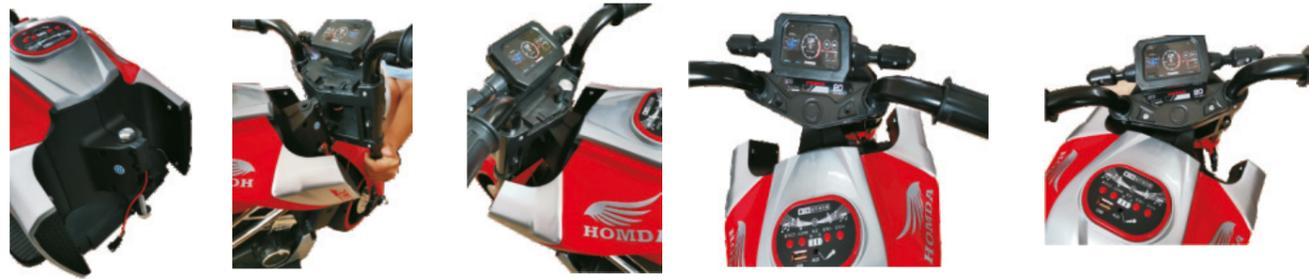
Demontieren Sie die Schraube am Lenkkopf. Stecken Sie die Gabel auf den Lenkkopf und befestigen diese mit der im vorhergehenden Schritt demontierten Schraube. Bringen Sie die Gabelbrückenverkleidung an und befestigen diese mit der dafür vorgesehenen Schraube.
