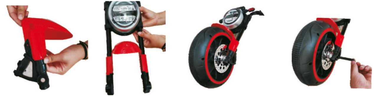
Stecken Sie den Kotflügel mit den Bremssattelimitaten zusammen und verschrauben diese mithilfe der 2 mitgelieferten Linsenkopfschrauben. Anschließend führen Sie die Gabel von oben durch den Kotflügel. Stecken Sie die mitgelieferten Bremsscheiben an das Vorderrad. Führen Sie die Vorderachse durch die Gabel und montieren das Vorderrad. Verwenden Sie dafür 2 Unterlegscheiben und 2 Sicherungsmuttern. Montieren Sie nun das mitgelieferte Displayimitat mithilfe der 2 mitgelieferten Linsenkopfschrauben.
