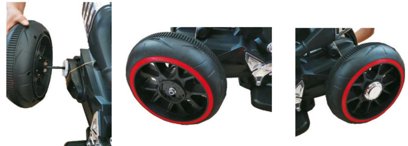
Führen Sie die Hinterachse durch beide Antriebsmotoren. Anschließend stecken Sie das Antriebsrad auf und achten darauf dass die Verzahnung, Antriebsmotor und Antriebsrad ineinander greifen. Sichern Sie das Antriebsrad mithilfe einer Unterlegscheibe und einer Sicherungsmutter. Zum Schluss bringen Sie die Radkappe an. Wiederholen Sie den Schritt auf der anderen Seite.
