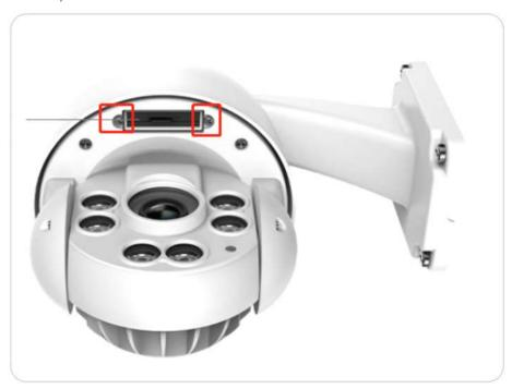
Schritt 2. Legen Sie die Micro-SD-Karte wie in der Abbildung unten gezeigt ein. Drücken Sie die Micro-SD-Karte mit dem Fingernagel (oder mit der mitgelieferten Rückstellnadel) ein, bis sie einrastet, Sie hören ein Klickgeräusch und die Micro-SD-Karte springt nicht heraus, wenn sie richtig eingelegt ist
