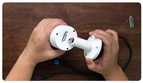
Schritt 2. Legen Sie die Micro-SD-Karte wie in der Abbildung unten gezeigt ein. Drücken Sie die Micro-SD-Karte mit dem Fingernagel (oder mit der mitgelieferten Rückstellnadel) hinein, bis sie einrastet, Sie hören ein Klickgeräusch und die Micro-SD-Karte springt nicht heraus, wenn sie richtig eingelegt ist
