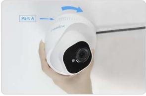
Schritt 4. Sobald die Kamera installiert ist, können Sie den Winkel um 70 Grad nach oben und unten oder 360 Grad horizontal einstellen.
