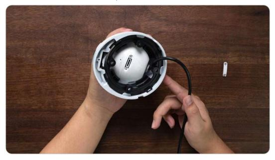
Schritt 2. Legen Sie die Micro-SD-Karte wie in der Abbildung unten gezeigt ein. Drücken Sie die Micro-SD-Karte mit dem Fingernagel (oder mit der mitgelieferten Rückstellnadel) ein, bis sie einrastet, Sie hören ein Klickgeräusch und die Micro-SD-Karte springt nicht heraus, wenn sie richtig eingelegt ist
