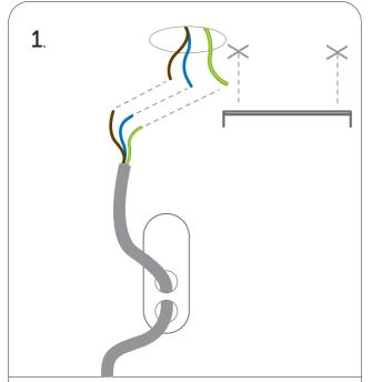
Die Leuchte ist so konstruiert, dass sie verpolungssicher angeschlossen werden kann. Schließen Sie ihre Phase (rot/blau/braun) und den Neutralleiter (rot/blau/braun) mit jeweils einem Anschlussleiter (blau oder braun) der Leuchte zusammen. Die Erdung ist grün/gelb gekennzeichnet.
