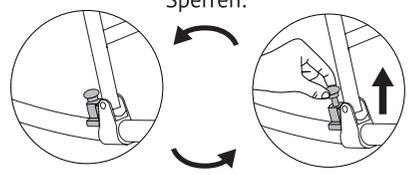
Ziehen Sie den Sicherheitsverschluss zum Entriegeln nach oben.
