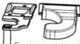
Cerniera superiore sini- stra per la reversibilità dello sportello
