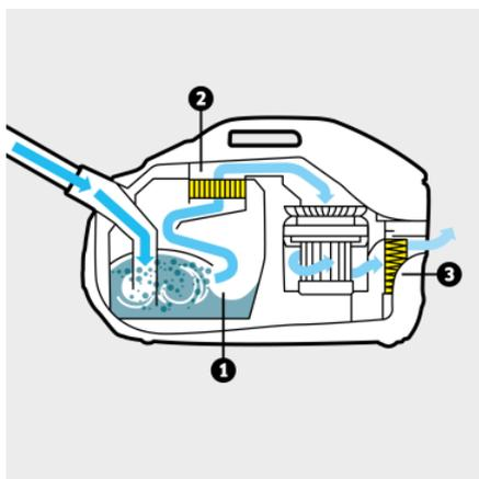
**Mehrstufiges Filtersystem bestehend aus innovativem Wasserfilter, auswaschbarem Zwischenfilter und HEPA 12-Filter (EN 1822:1998)**
