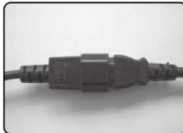
Der Anschluss des Bedienelementes erfolgt durch Verbindung dieser Stecker:
