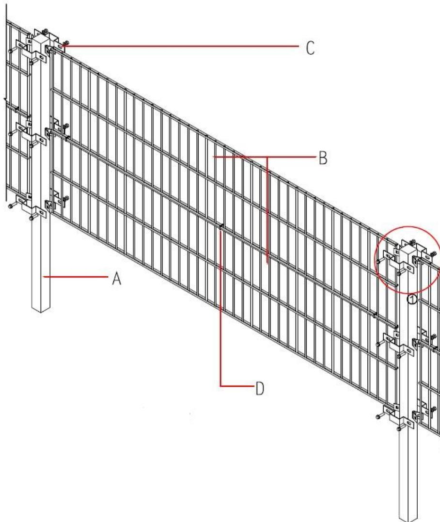
Zur Stabilisierung und Ausrichtung der Elemente zwischen den Pfosten nutzen Sie die 3 Schrauben (D).
