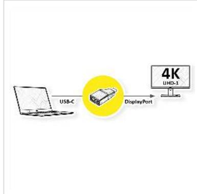
**Schließen Sie Ihr MacBook, Ultrabook, Notebook/Laptop oder PC oder ein mobiles Gerät mit USB-Typ-C-Anschluss an jedes DisplayPort-Display (Monitor oder Projektor) mit DP-Anschluss an - bei einer maximalen Auflösung von bis zu 3840x2160 @60Hz!**
