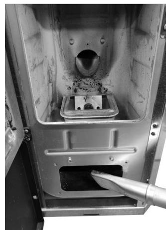
Fig. 75 - Die Asche absaugen
