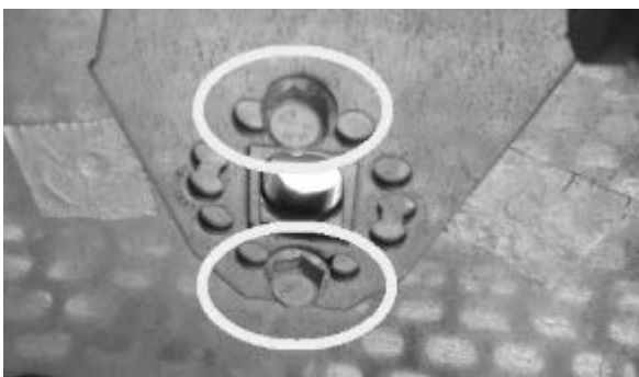
Fig. 81 - Die Schrauben entfernen
