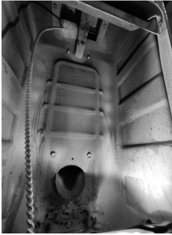
Fig. 76 - Mit einer Rohrreinigungsbürste reinigen
