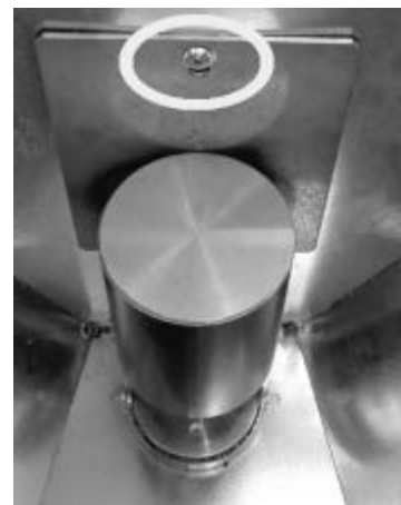
Fig. 82 - Entfernen der Schraube
