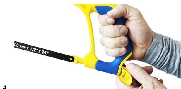
4.1. Die Enden des Bügelsägenrahmens sind mit Blatтарыerungen ausgestattet. Das S&R 126.300.001 Bügelsägeblatt verfügt über 2 Klemmpaare - zur Befestigung des Blattes in 90° und 45° zur zu bearbeitenden Fläche.
