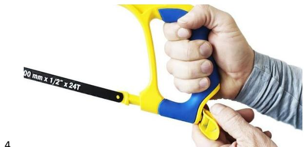
4.1. Los extremos del bastidor de la sierra para metales están equipados con bloqueos de la hoja. La hoja de sierra para metales S&R 126.300.001 tiene 2 pares de abrazaderas - para montar la hoja a 90° y 45° respecto a la superficie que se va a procesar.
