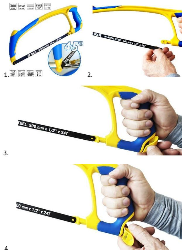
4.1. На кінцях рамки ножівки розташовані фіксатори ріжучого полотна. У ножівки S&R 126.300.001 є 2 пари фіксаторів - для встановлення полотна під кутом 90° і 45° до оброблюваної поверхні.
