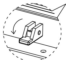
Lösen Sie die Verriegelung
