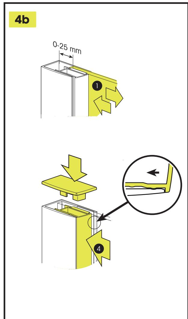
(D) Nach dem ausrichten der Dusche Klemmprofile ganz ein-drücken. Ein nachträgliches Lösen zum Nachjustieren ist möglich.
