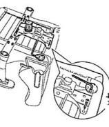
8. Stecken Sie den Sitz mit dem betestigten Mechanismus oben auf die Gasfeder
