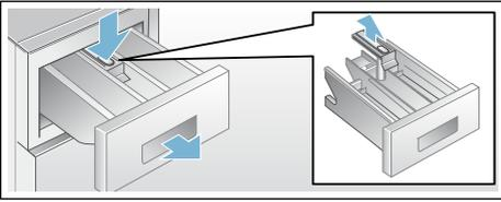
3. Einspülchale und Einsatz mit Wasser und Bürste reinigen und abtrocknen. Auch Gehäuse innen reinigen.
