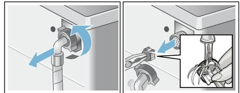
3. Schlauch anschließen und auf Dichtheit prüfen.
