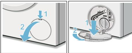
4. Entleerungsschlauch aus der Halterung nehmen.
