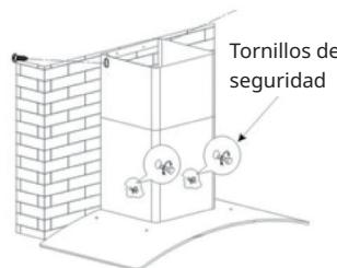
Exterior del armazón de la chimenea
