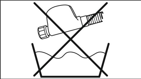
Das Gehäuse am Wasserzulaufschlauch nicht in Flüssigkeit tauchen!
