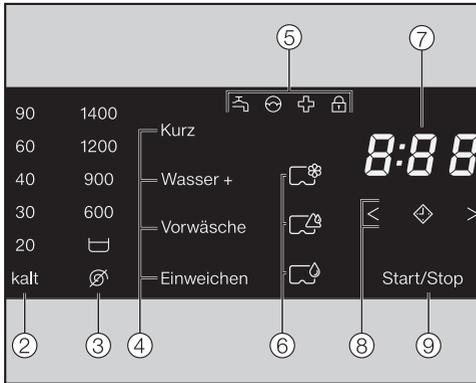
Die Sensortasten ②, ③, ④, ⑥, ⑧ und ⑨ reagieren auf Berührung mit den Fingerspitzen. Die Auswahl ist möglich, solange die jeweilige Sensortaste beleuchtet ist.
